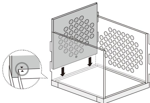
**9** ③バックパネルを同様に土台部分に差し込み
