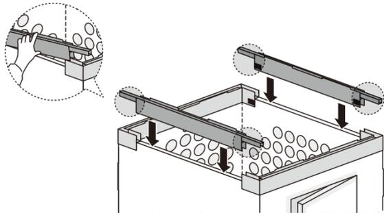
**23** ⑤前後継手を固定したのち、④側面継手を上図のように差し込んでいきます。この時、マジックテープがついている方を内側に差し込みます。
