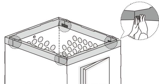
**24** 反対側も同様に固定したのち、上図のようにマジックテープで角4ヶ所を固定していきます。
