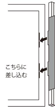
**3** パーツ④側面継手をパーツ⑪床面パネルに差し込みます。(対角面も同様に行います。)
