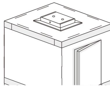
**29** ⑩天井パネルに⑫ファンユニットを取り付けた状態です。ブッシング穴に合わせて設置します。
