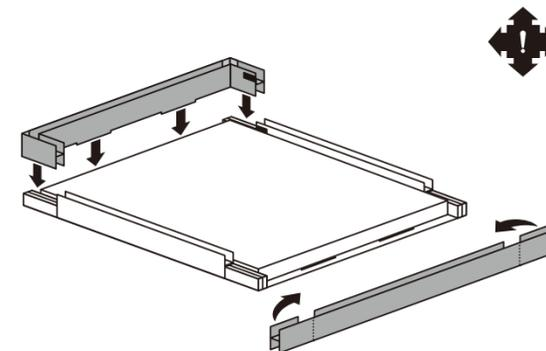
**5** パーツ④側面継手を両サイドに差し込んだ後、⑤前後継手を上図のように差し込みます。
