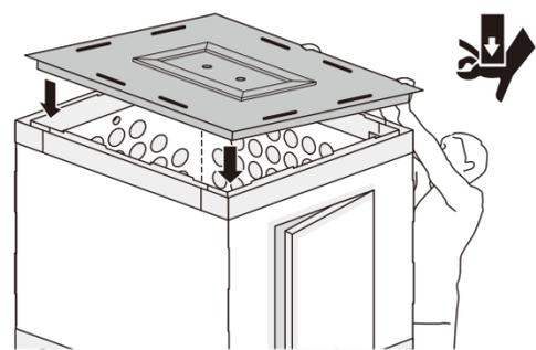
**26** 天井パネルを上図のように取り付けます。この時、天井パネルのミゾに継手の内側にある突起を押し込み固定します。
