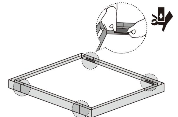
**6** ⑤前後継手を前後面に差し込んだ後、上図のようにマジックテープにて固定します。
